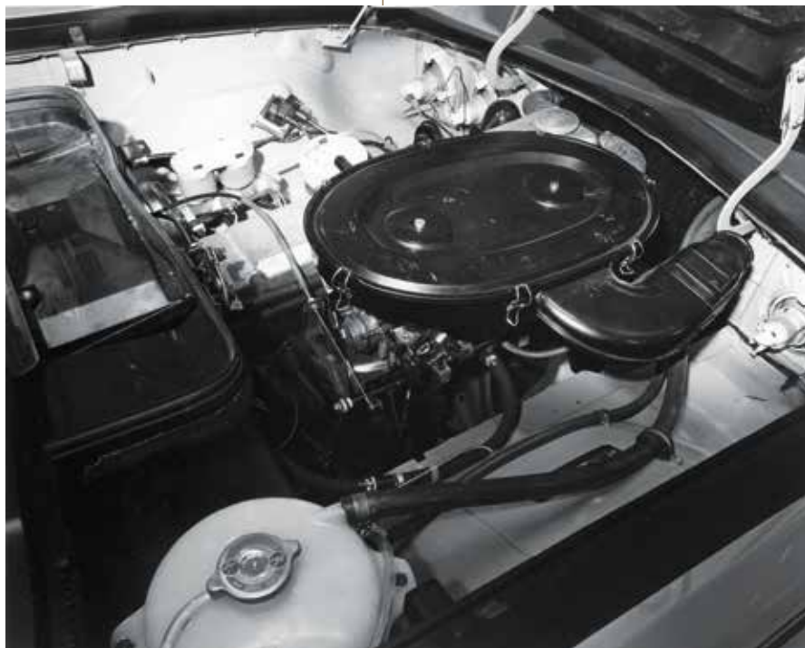
▲ Sous le capot de la TE-2800, on trouvait le bloc 6 cylindres 142 ch de la Commodore GS. La souplesse de ce moteur était telle qu'une boîte 4 rapports suffisait. Pour un usage sportif, une boîte 5 rapports de chez ZF était disponible. Photo: GM-Continental
